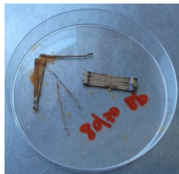
Fibre corrodibili, prova non superata
