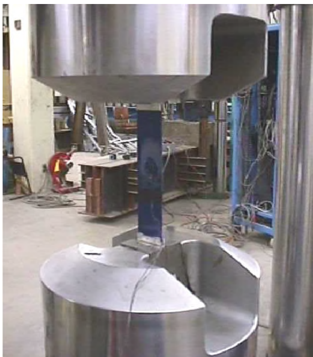
Esecuzione del test secondo ASTM D3039
